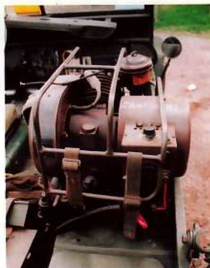
De 300 Watt BSA chore horse aggregaat levert 12 volt.
